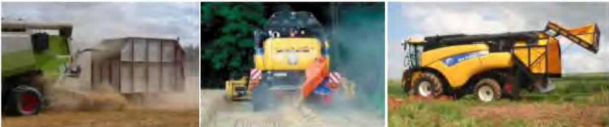
**Figura 4:** Sistemi per il recupero dei residui di trebbiatura, a turbina (sinistra) andanatori (centro) sistema per il recupero di pula e tutoli di mais (destra).
