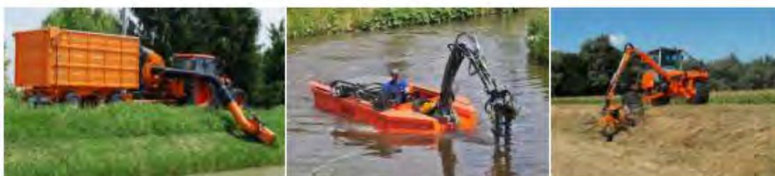
**Figura 6:** Sistemi per la gestione della vegetazione fluviale, di sponda (sinistra), di fondo (centro) e mezzi d'opera specifici (destra).
