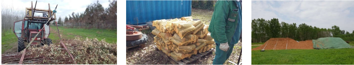
Figura 1. Allestimento prove di stoccaggio di Eucalipto in piante intere accatastate (A), in tronchetti confezionati in sacchi di rete (B) e in cumuli di cippato (C)
