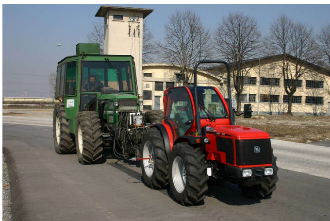
Figura 1. Esempio dell'allestimento di una prova di trazione press oil CREA-IT di Treviglio.
