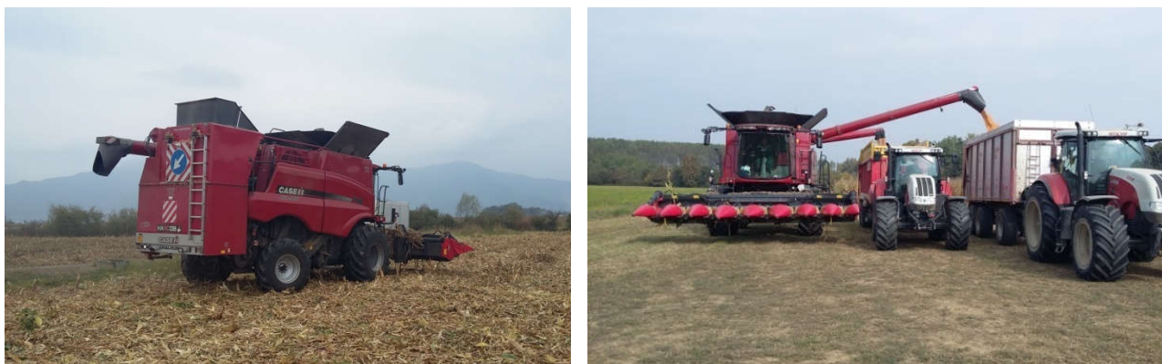
Figura 2. Il sistema “Harcob” montato su mietitrebbia Case Axial Flow 7140 e fase di scarico di tutoli e granella contemporaneamente
