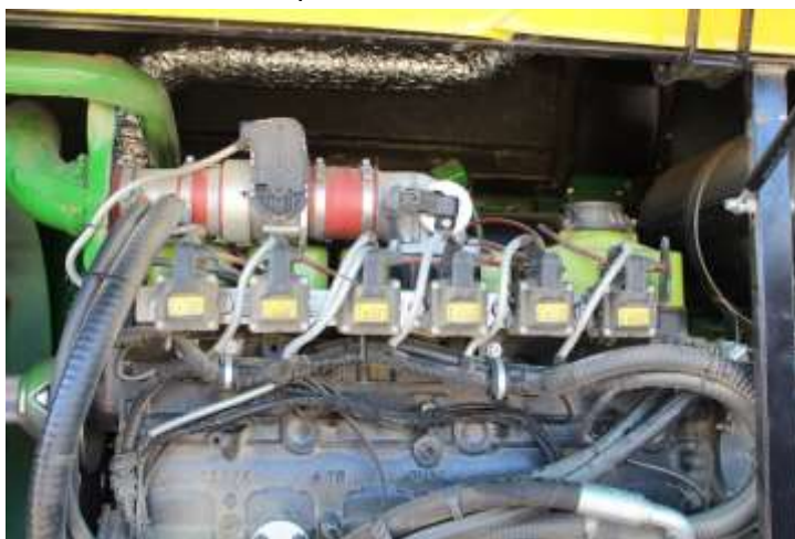
Fig. 2 – Il motore a 6 cilindri in linea del Rotomix 6000 modificato nella testata. E' in evidenza il sistema di iniezione elettronica Bosch deputato all'alimentazione del motore con metano.
