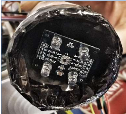
Fig. 5 – Sensore RGB con cameretta di lettura.
