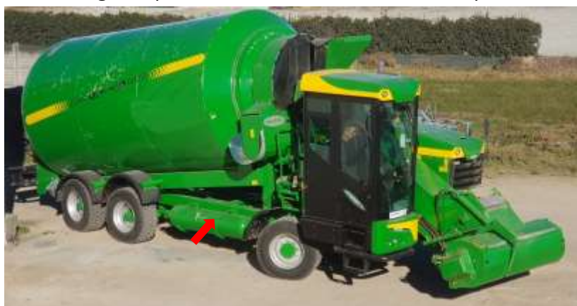
Fig. 1 – Il Rotomix 6000 Eco 5 modificato per poter essere alimentato a metano/biometano. La freccia indica la posizione dell'unica bombola installata.
