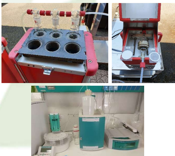
Figura 1. Sistema di campionamento per fase solida o volatile (in alto) e Cromatografo Ionico per la quantificazione (in basso)
