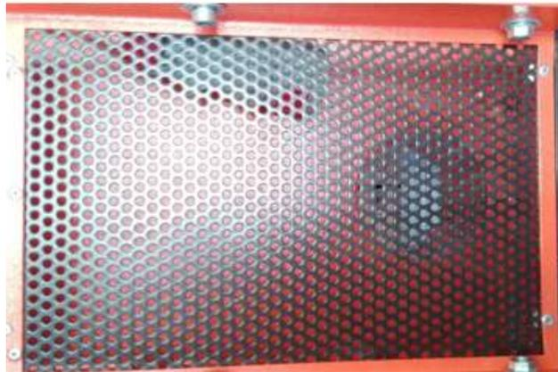
**Foto 10** - Vibrovaglio con fori da 5 mm.
