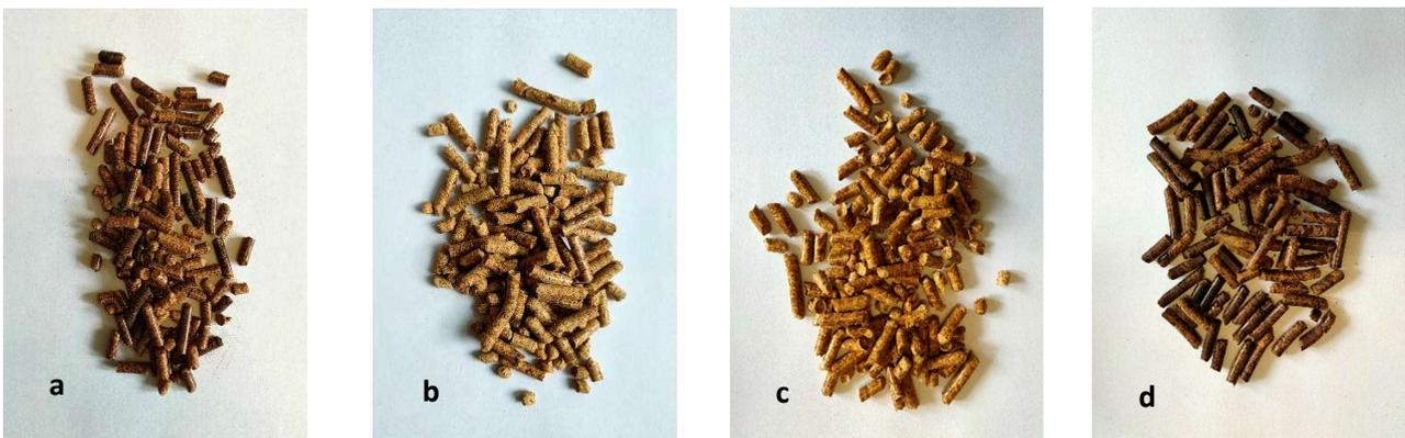
**Foto 33** - Pellet ottenuto dalla manutenzione del verde urbano: platano (a), eucalipto (b), pino domestico (c), leccio (d)
