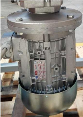
**Foto 7** - Propulsore elettrico da 4 kW
