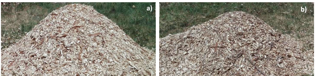
Foto 22 - Cippato di pioppo di 6 anni ottenuto con cippatrice forestale a disco Farmi Forest CH260: a) solo fusto, b) fusto e rami.
