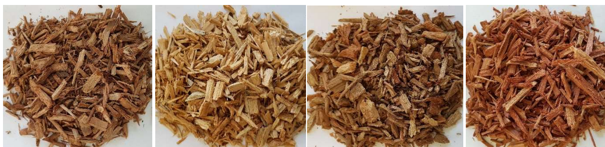
Foto 27 - Raffinato con griglia da 36 mm di leccio, pino, platano ed eucalipto, rispettivamente
