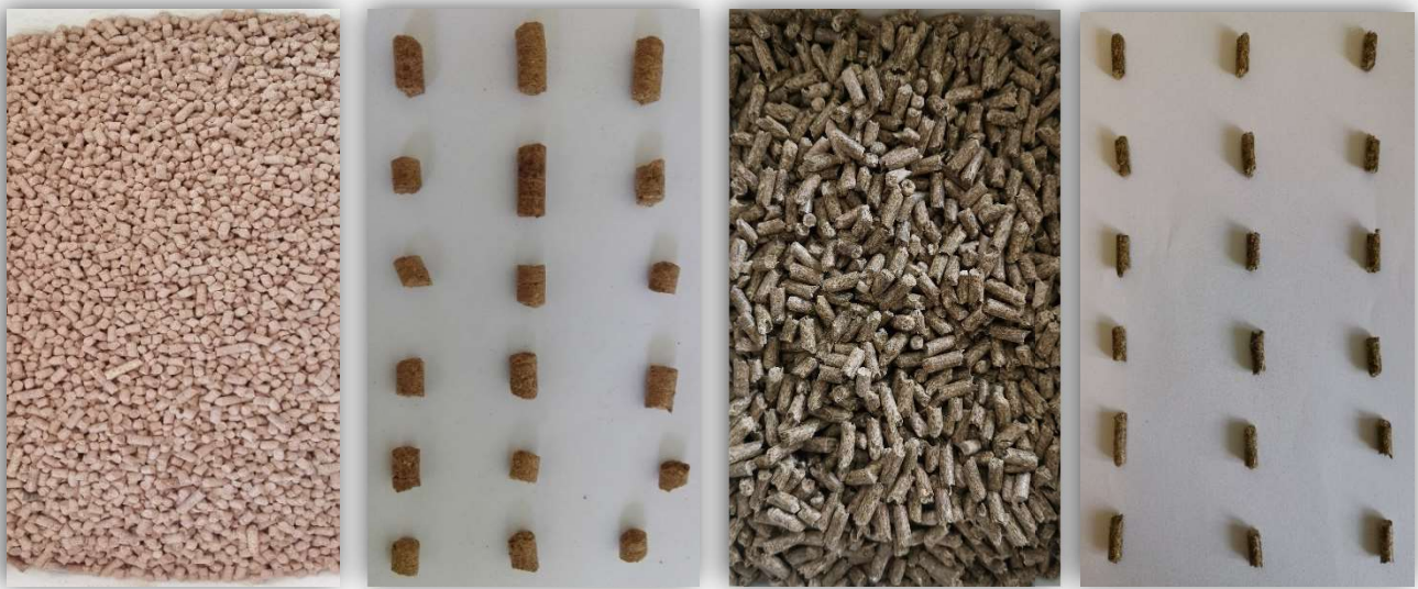
Foto 32 - Pellet ottenuto da potature di nocciolo biologico (a, b) e ulivo (c, d)
