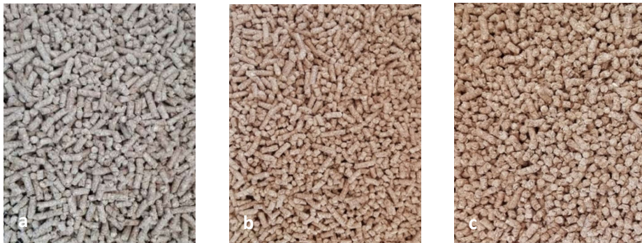
Foto 30 - Pellet ottenuto da SRF di pioppo: 9 anni pianta intera (a), 9 anni solo fusto (b), 9 anni ramaglie e cimoli (c)
