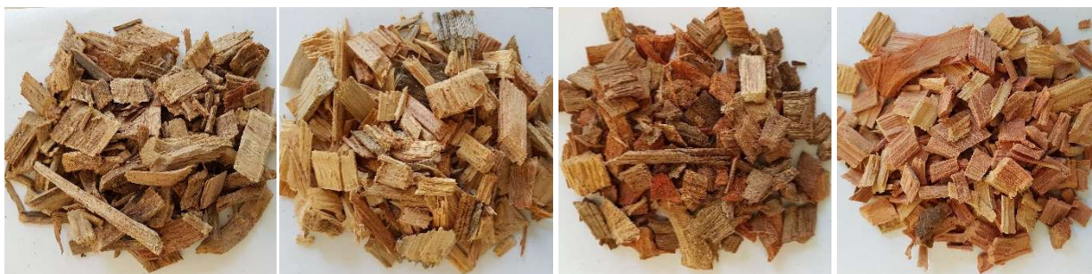
Foto 26 – Cippato di leccio, pino, platano ed eucalipto, rispettivamente
