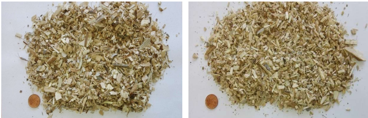
Foto 25 - Materiale legnoso proveniente da potature di nocciolo raffinato (griglia da 40 mm e 6 mm rispettivamente)
