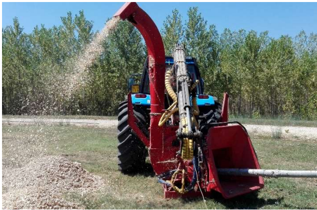
Foto 19 - Cippatura biomassa dopo periodo di stoccaggio con cippatrice forestale a disco Farmi Forest CH260.
