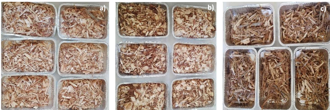
Foto 21 - Cippato di pioppo di 3 anni ottenuto con cippatrice forestale a disco Farmi Forest CH260. A colorazioni più chiare corrispondono prodotti con contenuto di corteccia e ramaglia inferiore [a) solo fusto, b) fusto e rami, c) solo rami].
