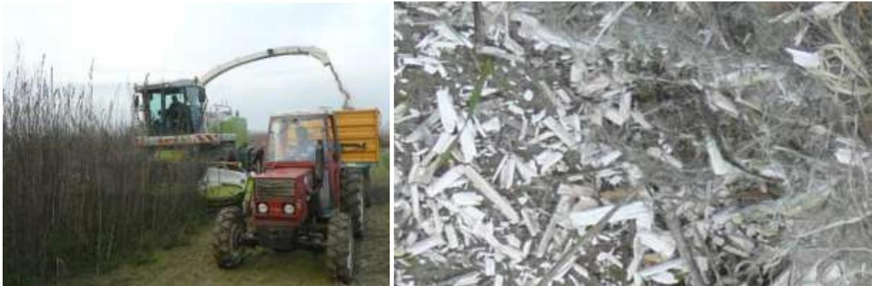
Figura 3 – Particolari della raccogliatrice e delle due frazioni ottenute parzialmente già separate dalla macchina.
