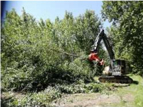
*Foto 1. Cesoia in fase di abbattimento e accatastamento della pianta di pioppo.*
