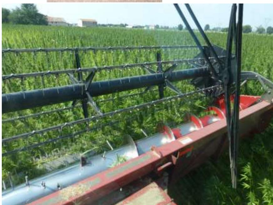
Figura 1 – Particolari del separatore installato e della macchina in lavoro con la parte di prodotto reciso ed in ingresso al gruppo di trebbiatura.
