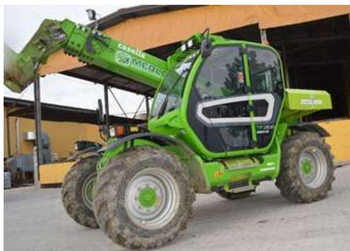
Fig. 2 – Caricatore telescopico trasformato a metano/biometano da una ditta specializzata. Si nota la posizione delle bombole sotto la cabina e sopra la ruota posteriore sinistra
