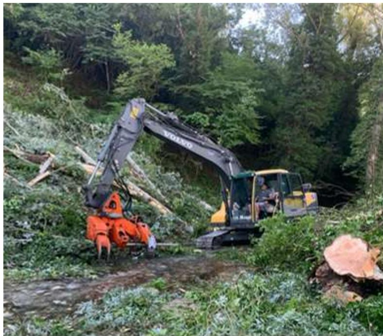
Figura 1: escavatore volvo con testa feller-buncher.
