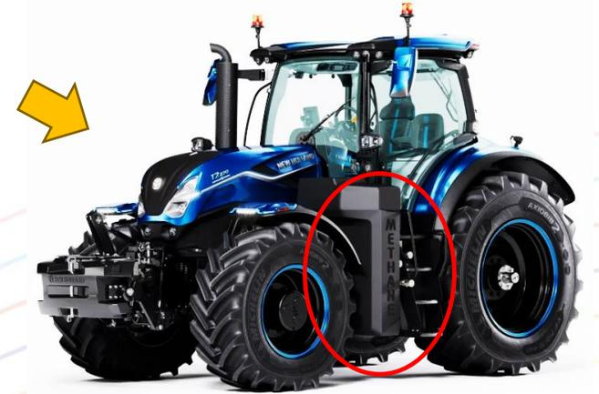
Prototipo di trattore a **LNG**; il serbatoio criogenico (-162°C) consentirebbe di **raddoppiarne l'autonomia** rispetto ai modelli a CNG (Foto profi, 2022)
