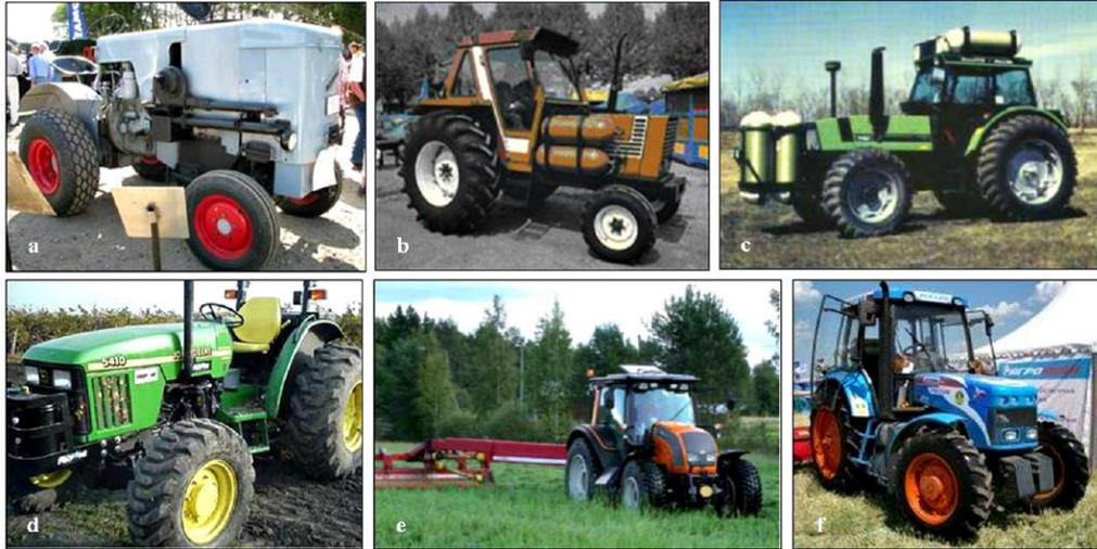
Esempi di trattori a **CNG**: a) Norman NG 25, 1942; b) prototipo a **biogas** (Università di Udine, 1982); c) prototipo a **metano** (Caddet, Canada, 1993); d) prototipo a **propano** (Birch, 2003); e) Trattore **dual fuel** diesel-metano (Valtra, Finland, 2009); f) trattore a **metano** (Traktorny Zavod, Russia, 2014).
