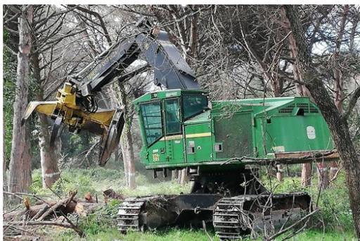
Foto 3. Feller-buncher John Deere 959J con testa abbattitrice con sega a disco.
