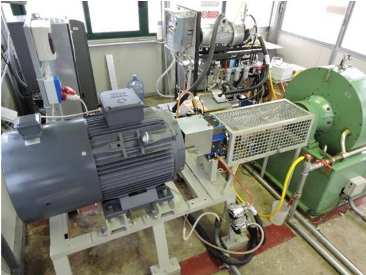
Il BPO presenta un unico circuito di base costituito da un serbatoio per l'olio, da una pompa di circolazione a bassa pressione, da un filtro principale e da uno scambiatore di calore, su cui si innestano due sezioni operative indipendenti:
