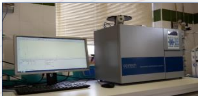
Determinazione del contenuto di C, H, N, S, O Analizzatore elementare Costech ECS 4010
