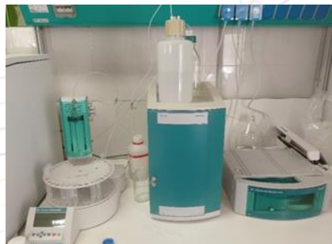
Cromatografo Ionico Metrohm ECO-IC + Detector Amperometrico Determinazione Anioni Cationi e Zuccheri
