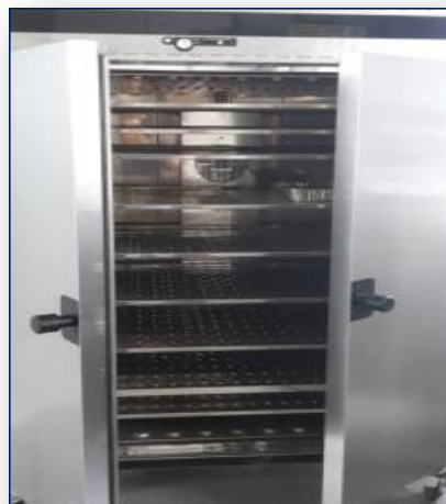
Determinazione umidità Stufa Memmert UFP800
